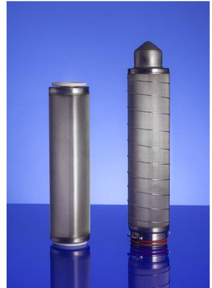
Gli elementi filtranti "SOLINOX" sono realizzati con reti e tele metalliche supportate da un anima d'acciaio inossidabile ad alta resistenza (slotted screen) alle cui estremità sono saldati i terminali. Gli elementi filtranti "SOLINOX" possono essere rigenerati con azione meccanica, in controcorrente, lavaggio chimico o con ultrasuoni.
