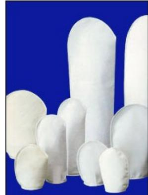
I sacchi filtranti BEAMESH incorporano un filter media costituito da filamenti sintetici (Nylon, Polipropilene, Poliestere) intrecciati a creare una maglia. Il filter media così strutturato, risulta particolarmente adatto alla filtrazione più grossolana permettendo inoltre facile rigenerazione del sacco.
