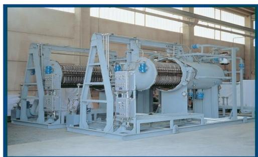
La foto mostra un filtro a foglia orizzontale in cui sono chiaramente visibili la centralina idraulica per la traslazione del pacco filtrante e l'apertura della chiusura rapida.
