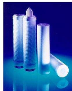
Toplife TPR è un filtro interamente realizzato in polipropilene avvolgendo intorno ad un canotto strati filtranti a diverso grado di trattenimento, in modo da ottenere una matrice filtrante con porosità decrescente dall'esterno verso l'interno. La consistenza degli strati filtranti utilizzati per la costruzione della serie TPR, conferisce una maggiore rigidità alla matrice porosa e permette di realizzare cartucce con gradi di filtrazione anche superiori ai 10 micron.
