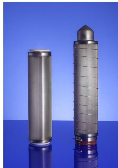
Gli elementi filtranti "SOLINOX" sono realizzati con reti e tele metalliche supportate da un anima d'acciaio inossidabile ad alta resistenza (slotted screen) alle cui estremità sono saldati i terminali. Gli elementi filtranti "SOLINOX" possono essere rigenerati con azione meccanica, in controcorrente, lavaggio chimico o con ultrasuoni.
