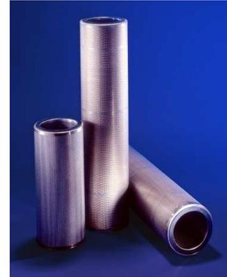
Gli elementi filtranti **DUALSEP** sono realizzati con matrice filtrante pieghettata composta da due differenti strati: il primo strato ha la capacità di trattenere elevate quantità di contaminante particellare, il secondo agglomera le particelle liquide in gocce più grandi.
