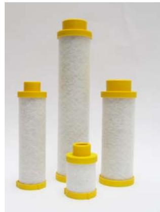
Realizzati con filter media composti impregnati con micro-particelle di **CARBONE ATTIVO**, gli elementi filtranti **ARS-CA** rimuovono gli agenti inquinanti per mezzo del fenomeno fisico dell'**ADSORBIMENTO**; esso consiste nell'instaurarsi di forti attrazioni molecolari tra la superficie delle particelle solide di carbone attivo e le molecole inquinanti presenti nell'aria.
