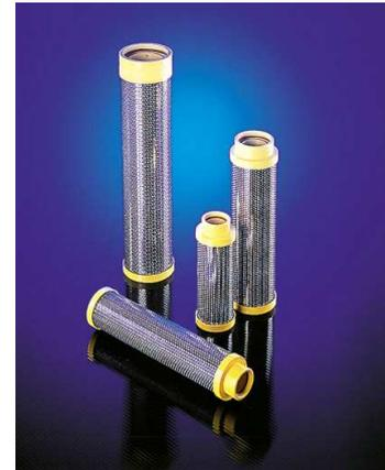
Il fluido contaminato attraversa il filtro dall'interno verso l'esterno; le particelle solide vengono trattenute all'interno del setto filtrante mentre le particelle liquide ingrossate dall'azione coalescente del filter media cadono per gravità nella zona di calma del contenitore.
