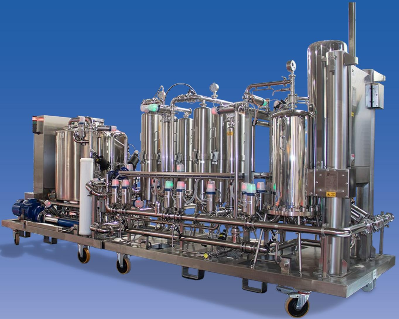
BEA Technologies diseña y suministra sistemas de filtración automáticos para la filtración de agua, vino y bebidas.
