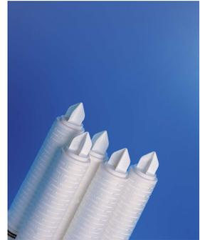
La cartouche membrane plissée PES VINOKLARIS (Polyethersulphone hydrophile) est spécialement étudiée pour la filtration stérilisante finale de vin offrant un intéressant ratio coût/avantage et d'excellentes performances dans la stabilisation microbienne à froid.
