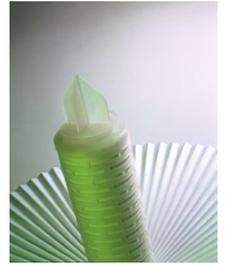
POLYSAN-PKP es obtenido plisando hasta 5 capas de polipropileno de una porosidad decreciente para conseguir una gran área de filtración efectiva, alta capacidad de retención de suciedad y un preciso y controlado rango de filtración. Todos los componentes de polipropileno están ensamblados por termo fusión.
